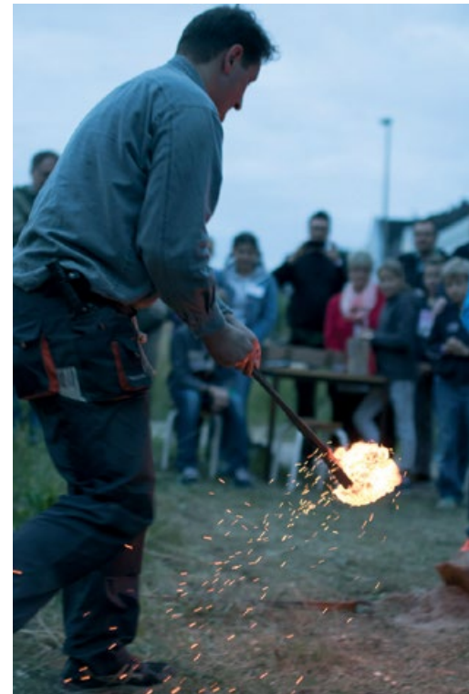
Unser selbstgebauter Rennofen - Phil, die Schlacke rinnt, der Ofen muss nun bald geöffnet werden. Gut gemacht! - Solange die Luppe noch heiß ist, muss sie verdichtet werden, d.h. aus der Luppe muss jetzt die flüssige Schlacke durch Schlagen herausgetrieben werden.
