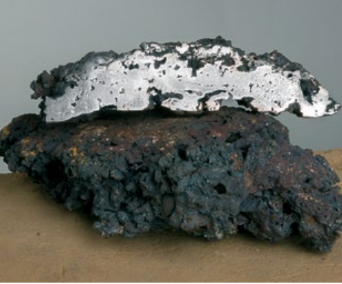
Der Eisenschwamm aufgesägt und poliert - Aufstellen und hüpschen des Rennofens - Frau Bursche erzählt über das Projekt und Phil im Hintergrund fährt den Ofen.
