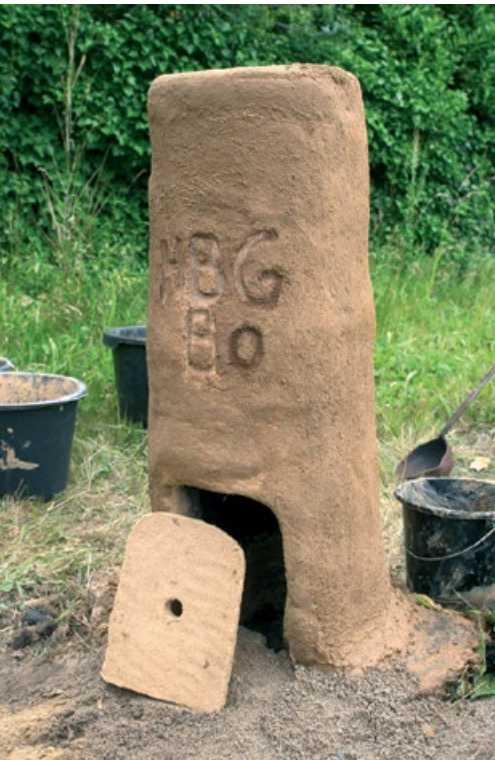
Unser selbstgebauter Rennofen - Phil, die Schlacke rinnt, der Ofen muss nun bald geöffnet werden. Gut gemacht! - Solange die Luppe noch heiß ist, muss sie verdichtet werden, d.h. aus der Luppe muss jetzt die flüssige Schlacke durch Schlagen herausgetrieben werden.
