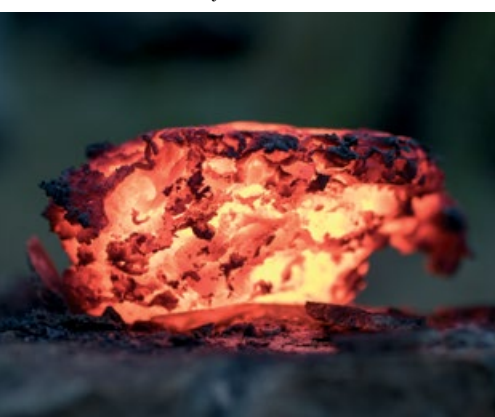
oben: Die Schlacke rinnt aus dem Ofen - Frau Bursche und Herr Bursche öffnen den Ofen - Der Klumpen ist der Eisenschwamm, auch Luppe genannt - unten: Unser Eisenschwamm, auch Luppe genannt - Viele Gäste besuchten unser Rennofenprojekt bei der Extraschicht. Selin und Johanne leiteten die Herstellung von Ledersäckchen an. - Besucher üben sich im Schmieden von Baustahlstangen
