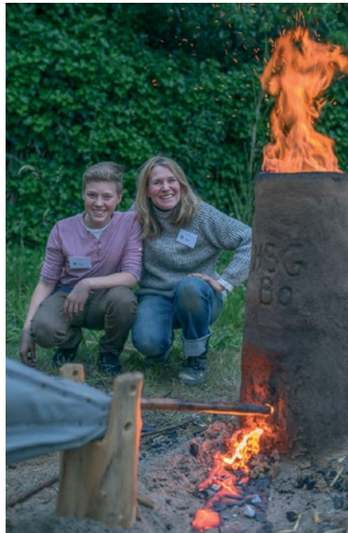
Unser selbstgebauter Rennofen - Phil, die Schlacke rinnt, der Ofen muss nun bald geöffnet werden. Gut gemacht! - Solange die Luppe noch heiß ist, muss sie verdichtet werden, d.h. aus der Luppe muss jetzt die flüssige Schlacke durch Schlagen herausgetrieben werden.
