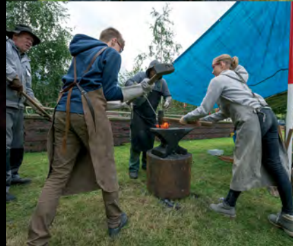
3 Philippe am Blasebalg 6 Gichtfeuer 8 und 9 Ausschmieden der Luppe: Phil und Johanna schlagen zu 11 Ergebnis: Unser Eisenbarren – vorbereitet für eine zweite Faltung
