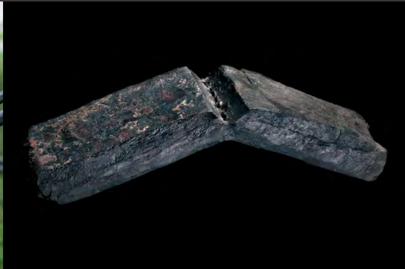
3 Philippe am Blasebalg 6 Gichtfeuer 8 und 9 Ausschmieden der Luppe: Phil und Johanna schlagen zu 11 Ergebnis: Unser Eisenbarren – vorbereitet für eine zweite Faltung
